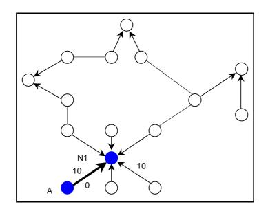
N1 に隣接するノードへのコストを計算します。マルチアクセスネットワークからの入力はコスト 0 ですから、コスト 10 で B/C/D/E/F に至ることができます。次に探索する候補は、G と K になり、それぞれのコストは 110 と 60 ですから、コストの小さい K を先に計算していきます。
