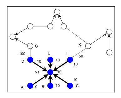
SPF 木に K を加えます。次の候補は、前のステップで後回しにされた G( 3 + 110) と、J( 3 + 115) N4 ( 3 + 110) です。最小コストの N4 を選択します。
