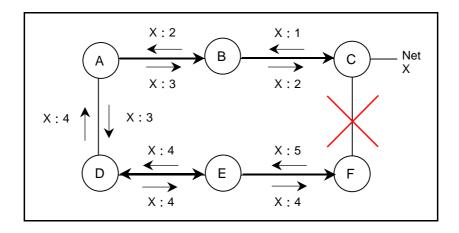
ルータ E は、D から X への経路 (メトリック 4) と、F から X への経路 (メトリック 4) を比較しどちらかを採用します。F から伝えられる X に至る経路のメトリック値が 5 に増加します。F の時点で、E は X 宛の経路として F を選択します。F が F への経路として F を選択している場合には、F と F の経路がループしている状態となります。
