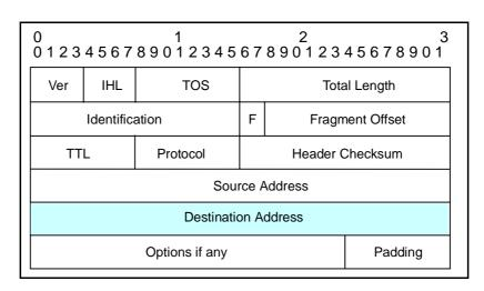
Ethernet ブリッジでは、Ethernet フレームの先頭に宛先アドレスがありますから、先頭を見れば中継作業を開始することができます。IP ルータはパケットを全部受け取ってから中継作業を行いますが、現在では、宛先アドレスを受け取った途端に中継作業を開始するルータもあります。
