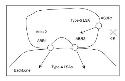
OSPFでは、エリア内部のルータ全てが合意した場合に、エリアをスタブエリアとすることができます。スタブエリアでは、外部経路を取り扱わず、デフォルト経路を使用するので、Type-5 LSA は伝達しません。
