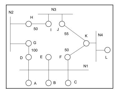
まず、マルチアクセスネットワークも 1 つのノードとして表し、その出力側 にコストを与えながら、ネットワーク全体のトポロジをグラフ化します。 ノード A における経路テーブルを得るために、A に対する SPF 木を計算します。
