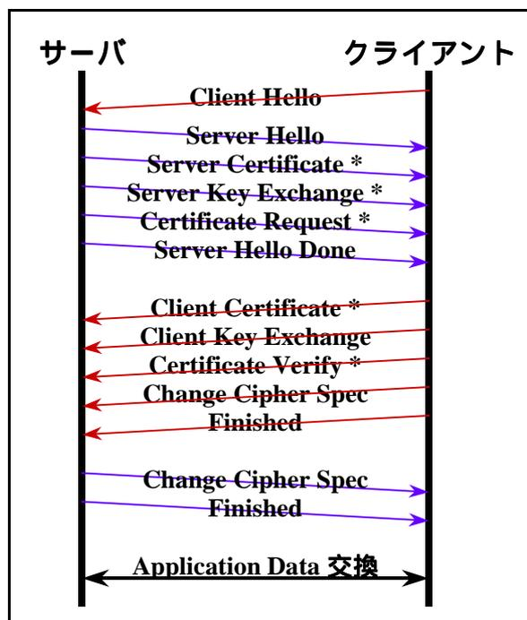
ここでは、最初にクライアントが Client Hello を送り、それに対してサーバが Server Hello を返すことでセッションが開始されます。次に、サーバは、自らの証明書である Server Certificate か証明書の代わりとなる Server Key Exchange をクライアントに送った後、Server Hello Done によって送信の終了を告げます。クライアントが Client Key Exchange を送ることで、暗号化などのためのネゴシエーションが終了します。そして、クライアントとサーバが互いに Change Cipher Spec と Finished を送り、設定した暗号化アルゴリズムやセッション鍵などを利用し始めます。また、このようなクライアントとサーバ間でのやりとりでは、クライアントに対する認証を実施するために、Certificate Request、Client Certificate、Certificate Verify というオプションが利用されることもあります。
