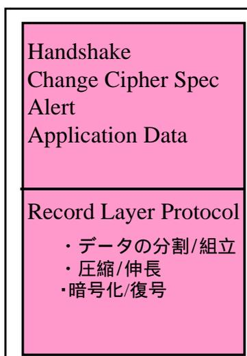
このうち Record Layer Protocol では、 $2^{14}$  バイト以下にデータを分割し、必要に応じて圧縮処理、認証データ付加、暗号化処理を実施して、次のようなデータ構造体を生成して送受信に利用しています。
