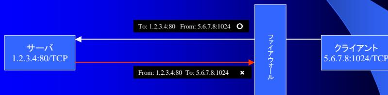
1方向を許可しただけの単純なフィルタリングでは「行きはよいよい、帰りは...」で通信が成り立たない。
