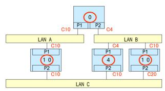
Root Bridge を 0 とした Root Path Cost を Configuration BPDU で送信。受信した各 Bridge で Port Path Cost を足し、受信した Bridge の Root Path Cost とする。
