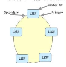
リング内で master SW を選ぶ。 master SW の一方を Primary、もう一方を Secondary とする。 Secondary を BLOCKING す
