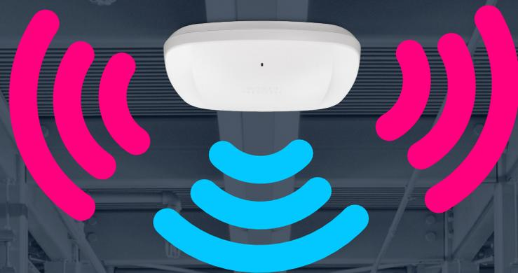
無指向性アンテナは「**全方向**」に電波が飛びます
