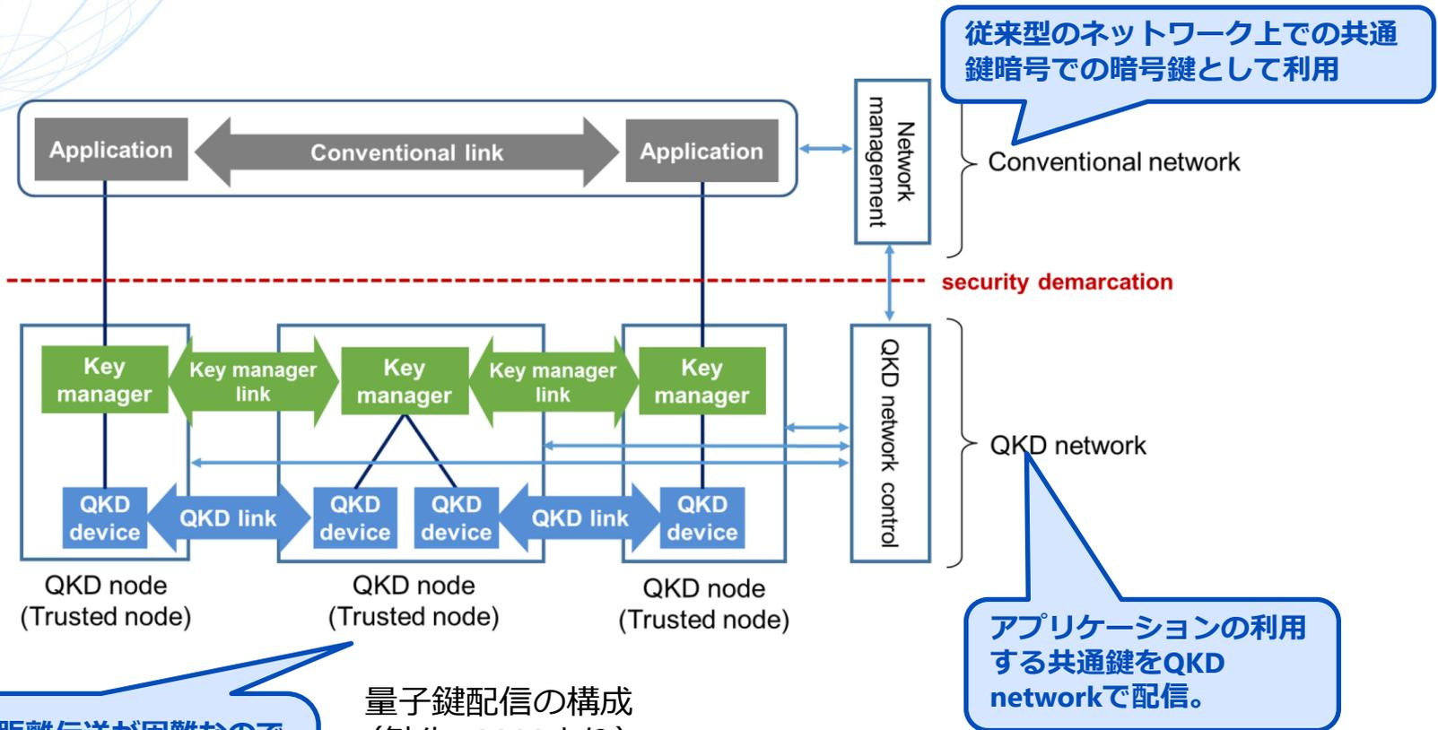
量子暗号は長距離伝送が困難なので必要に応じて中継ノードを設置。中継ノードは何らかの方法で信頼関係が確立されているとの想定。
