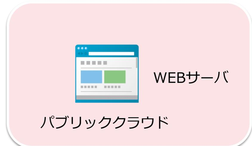
WEBはパブリッククラウド上で冗長化されていたが、権威DNSは役場に集中していた。結果として、台風で役場が停電、WEBサーバのIPアドレスが引けなくなり、災害時の情報発信に支障をきたしました。
